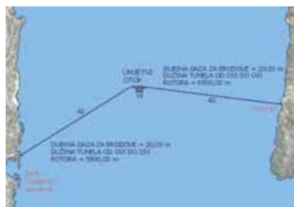
Trasa potopljenog tunela između Splita i Brača s umjetnim otokom
